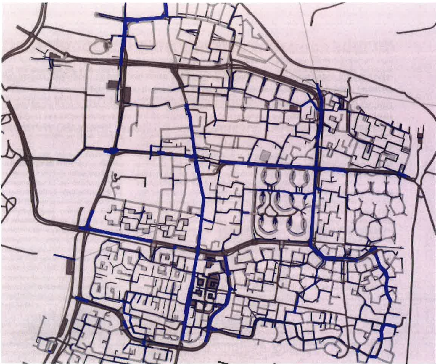
Figuur 2; Een overzicht van het rioolstelsel met 'gewogen' riolen waarbij de lijndikte en kleur de belangrijkheid van elk individueel riool weergeeft.
